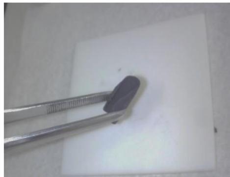
導電性高分子を用いたフレキシブル熱電変換デバイス
