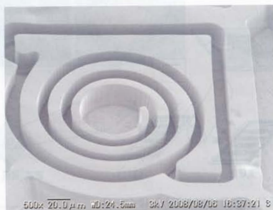
電鍍成型によるNi-W合金スパイラルセル部品
