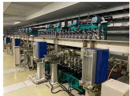
図 3. 挿入光源 極短パルス光の生成に向けた世界初の実証実験です (理化学研究所との共同研究)。
