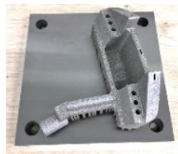
図3. 3Dプリンタで製作したパターヘッドの一例
