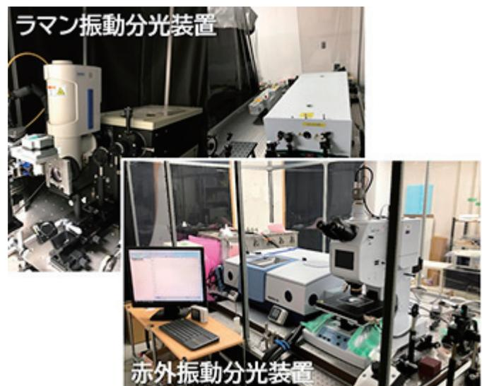
図2 時分割測定用振動分光装置
