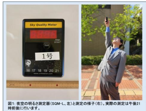
図1: 夜空の明るさ測定器(SQM-L、左)と測定の様子(右)。実際の測定は午後21時前後に行います。
