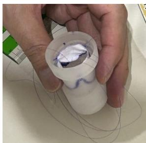
3D プリンタで作成した基部への心臓弁尖を取り付け
