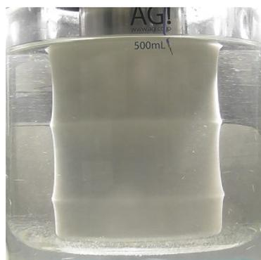
図1 回転する円管の表面に析出した脂肪酸の層状結晶
