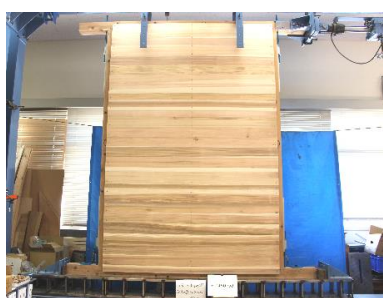
写真1 面内せん断試験の様子
