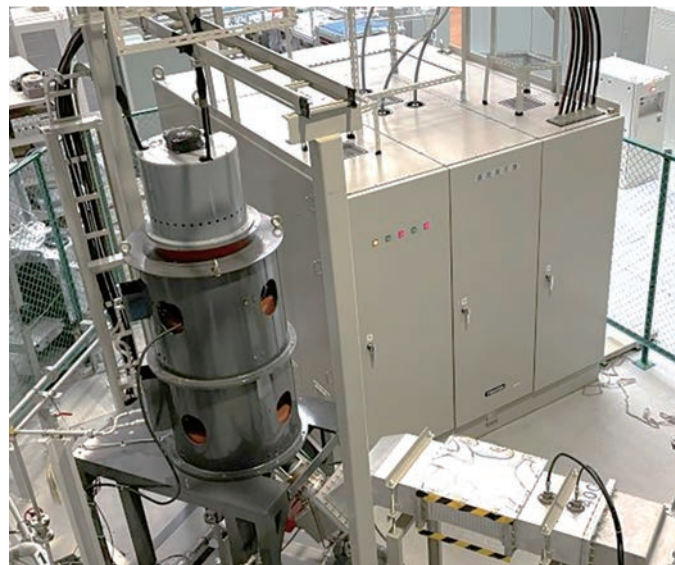
図3. 寄付により改修予定のクライストロン電源.
