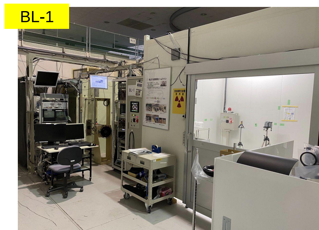
レーザーコンプトンガンマ線源 0.5 - 76 MeVのガンマ線発生可能
