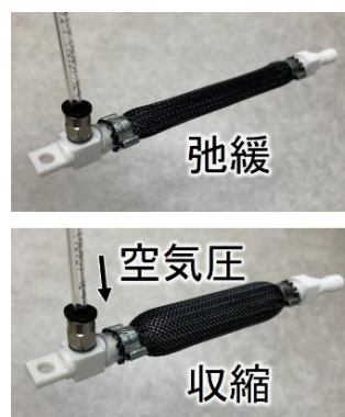
図2 マッキベン型人工筋肉
