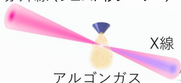
図 1 高次高調波による X 線の発生。赤外線とアルゴンを用いて X 線が発生する。
