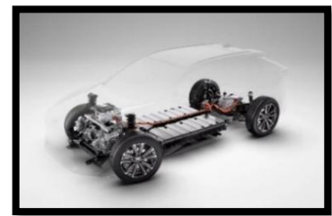
図1 電気自動車のバッテリーの配置。シャシー中央部の広いエリアにおいて充放電時の効率的な冷却が求められる 1) 。
