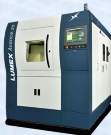
【講習会使用設備】 (株)松浦機械製作所製 LUMEX Avance-25 (レーザービーム型)
