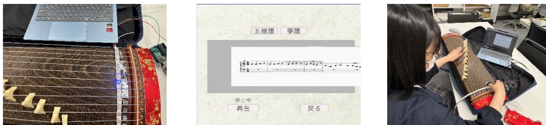
図 1: 提案システム (左: LED による弦提示, 中央: 提案システム画面, 右: 演奏の様子)
